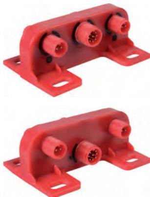
Die Kabelverbindungsdose dient dazu innerhalb des LEDsInno-Systems Leuchten miteinander zu verbinden. Sie verfügt über zwei 8-polige Ausgänge für LEDsInno Heckleuchten und vier 2-polige Ausgänge für LEDsInno Zubehör (Seitenmarkierungsleuchten, Umrissleuchten etc. ).
