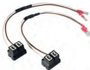
Der Keramik-Glühlampenanschlussstecker für H7- Glühlampen ist in der Pluszuleitung mit einer Diode versehen. Diese Diode senkt die anliegende Spannung um 0,8 V auf eine optimale Glühlampenspannung. Dadurch wird die H7-Glühlampe vor erhöhten Span-
