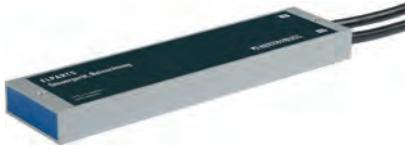
Widerstands-Ersatzlast zur Anpassung von Leuchtdioden- Anhängerleuchten an Fahrzeugen mit Glühlampenüberwachung. Der Ausfall einer LED-Einheit wird erkannt und die Ersatzlast abgeschaltet.
